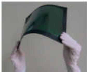
フィルム型ペロブスカイト太陽電池（写真提供：株式会社東芝） ※この成果は、国立研究開発法人新エネルギー・産業技術総合開発機構（NEDO）の委託業務の結果得られたものです。
